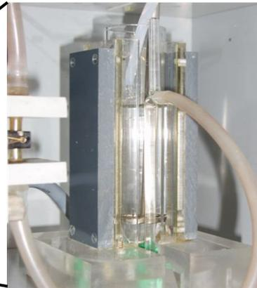
Abb. 1.3.12: Nahaufnahme einer der Messkammern aus Glas in der Halterung mit seitlich integrierten Lichtschranken
