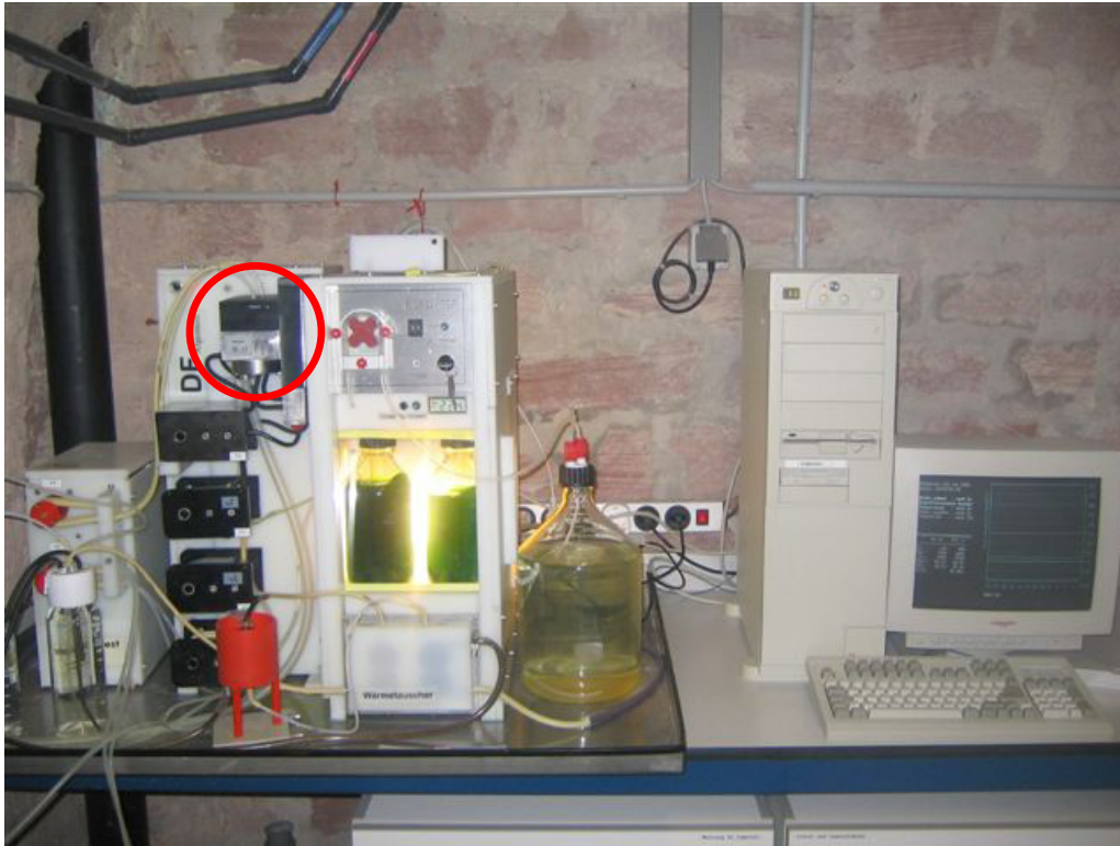
Abb. 1.3.13: Aktuelle Version des DF-Algentests nach dem Umbau 2003, der vor allem den rot eingekreisten Bereich betraf.
