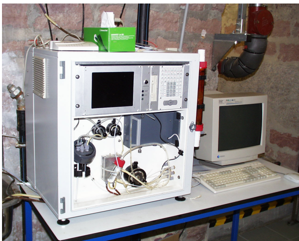
Abb. 1.3.12: Das bbe-Daphnientoximeter an seinem Standort in der Rheingütestation
