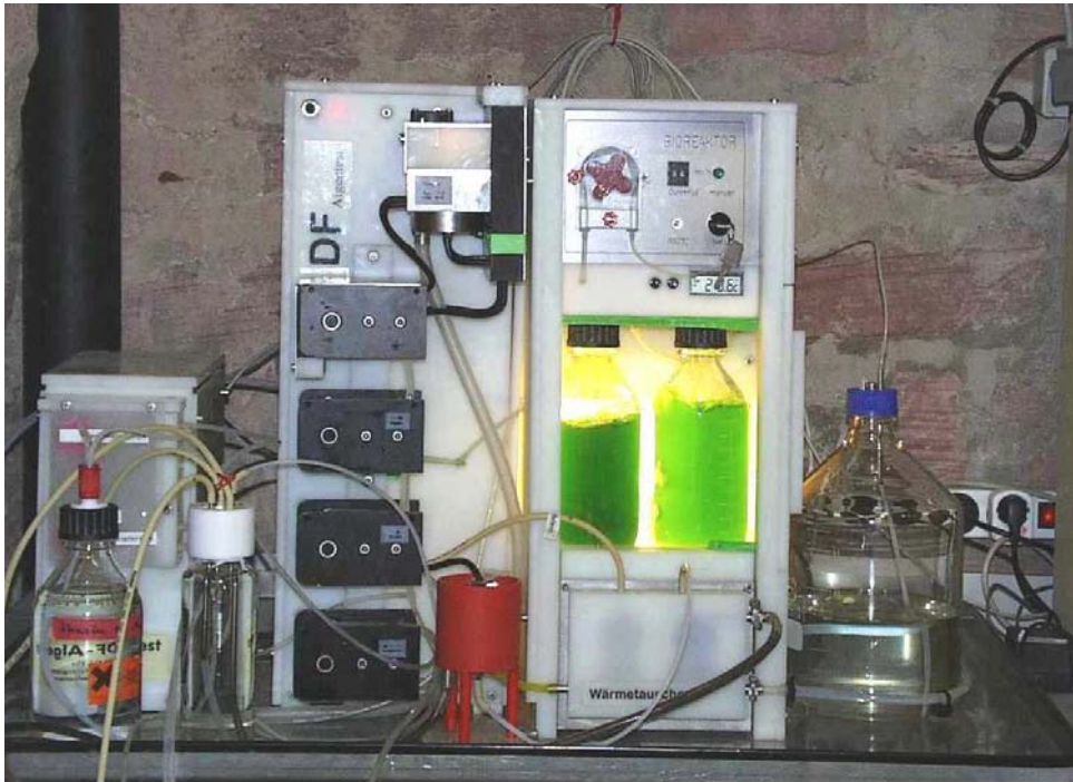
Abb. 1.3.10 Algentest an seinem Standort in der RGS Aufstellung von links nach rechts: Add-on für den täglich durchgeführten Empfindlichkeitstest mit Atrazin, Messgerät, Algenhälterung, Flasche mit Nährmedium für die Algen, PC zur Aufzeichnung und Auswertung der Daten.
