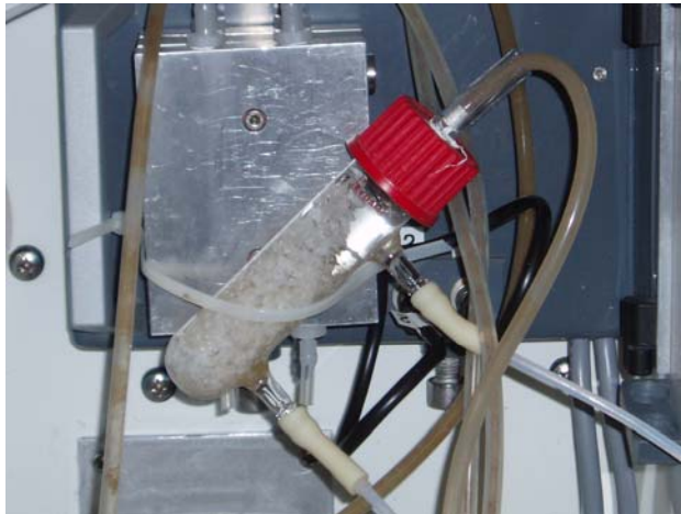
Abb. 1.3.8: Ausgasungsgefäß mit Teflonspäne und Verschlauchung am Deckel zum Abtransport von Luftblasen.
